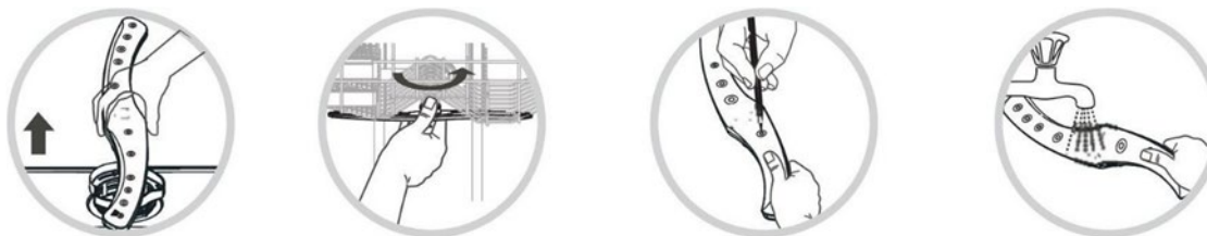
Рис. 30. Порядок снятия и очистки распылительного рукава
