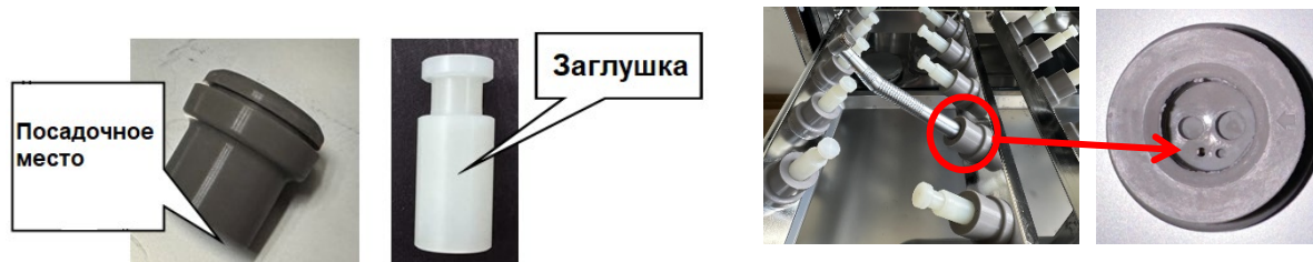
Рис. 25. Узел подключения турбинного наконечника (силиконовое посадочное место и заглушка)
