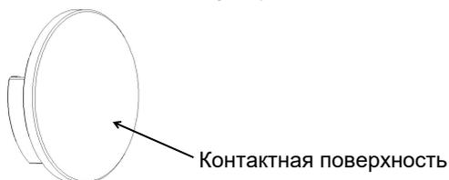
2. Приклейте Т-образную выемку для пузырька на относительно вертикальную плоскость с краю блока инструментов стоматологической установки (п примечание: Т-образная выемка должна располагаться вертикально):
