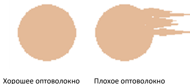
Рис. 2.13 Точка направляющего луча, излучаемого хорошим оптоволоконном и плохим оптоволоконном в сравнении
