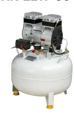
Количество **установок:** 1. Напряжение: 220 В. Потребляемый **TOK:** 2.4 A. Производительность: 100 л\мин. Максимальное давление: 0.8 МПа. Объем ресивера: 35 л. Источник питания: 50 Гц. **Мощность:** 550 Вт.
