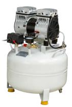
Количество **установок:** 1. Напряжение: 220 В. Потребляемый **TOK:** 2.4 A. Производительность: 70 л\мин. Максимальное давление: 0.8 МПа. Объем ресивера: 30 л. Источник питания: 50 Гц. **Мощность:** 550 Вт.
